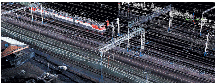
Облако точек лазерных отражений (ТЛО), окрашенное с использованием фотоснимков. данные мобильного лазерного сканирования (ж/д станция Севербайкальск)
