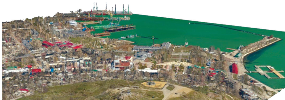
Рис. 2. Облако точек лазерного сканирования порта г. Керчь, текстурированное ортофотопланом
