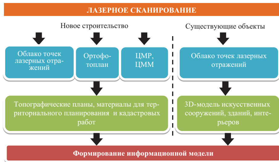
Рис. 1. Схема формирования информационной модели
