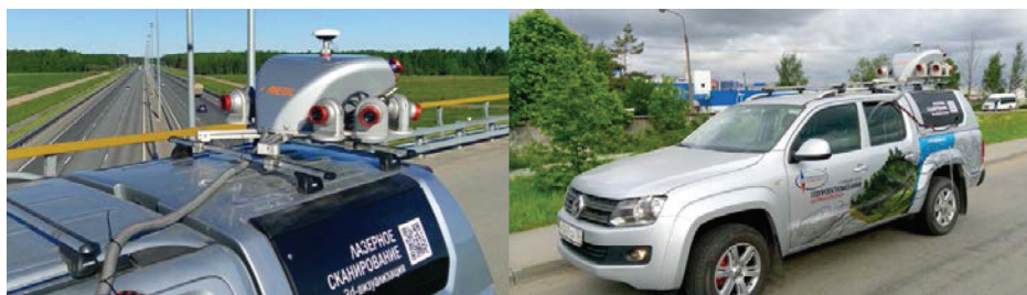
Рис. 8. Мобильная сканирующая система RIEGL VMX-450
